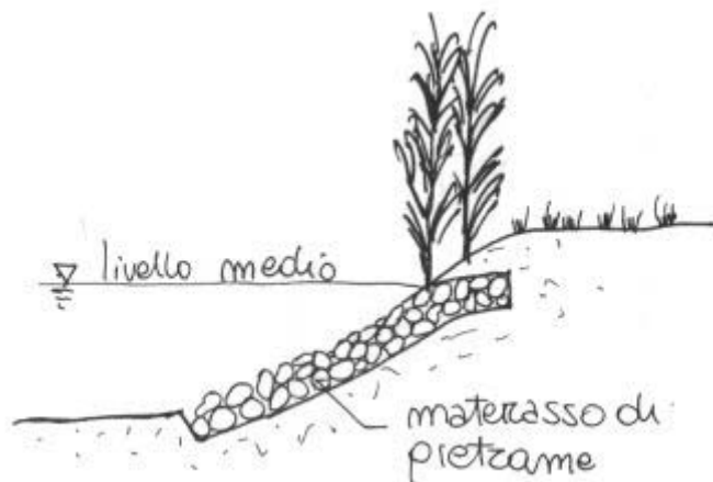
Fig. 12: Rivestimento spondale con materassi di pietre.
